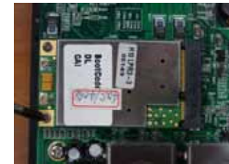
Installing mini card Modules
